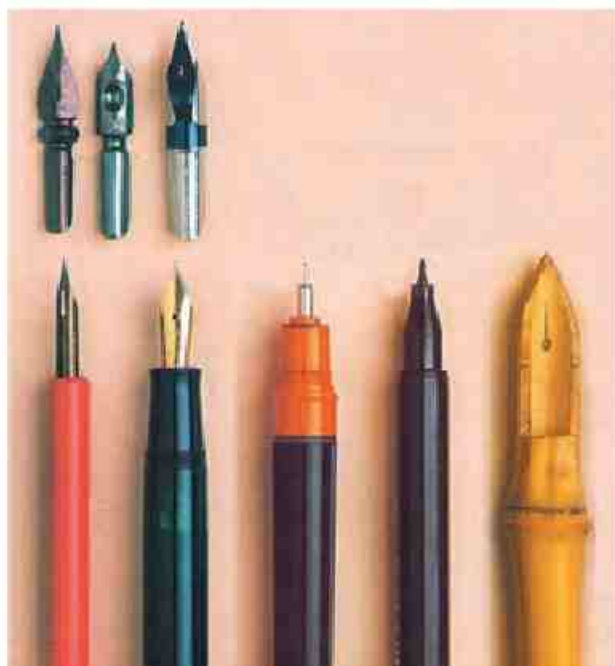
تصویر ۲-۲۴- از راست به چپ: قلم نی، روان‌نویس، رابینوگراف، خودنویس، قلم آهنی (با چند نوع نوک اضافه که می‌توان بر بدنه آن سوار کرد).
